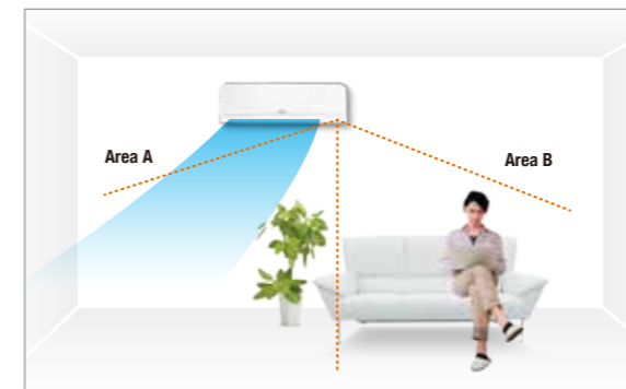
Jika seseorang dideteksi di area B, aliran udara diarahkan Area A.
